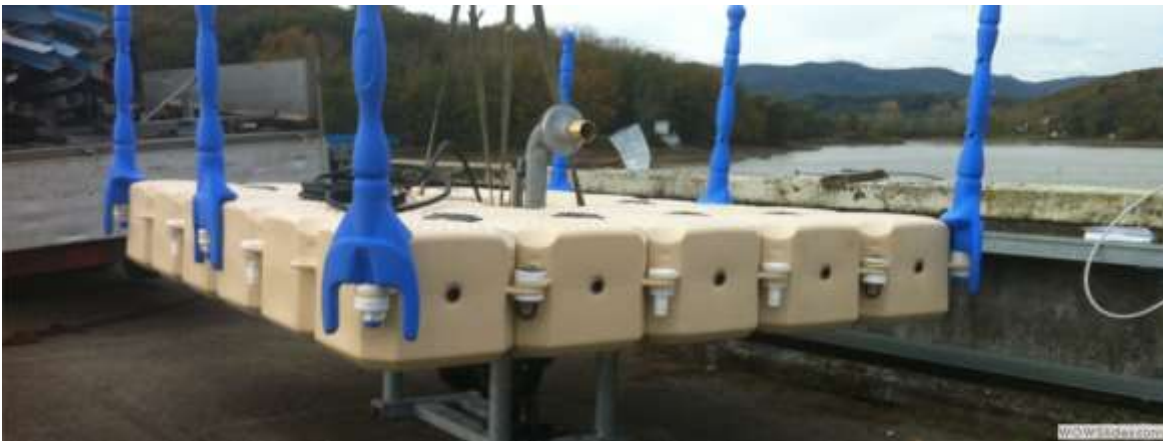
Piattaforma per pompa di pescaggio in bacino idrico – sottostruttura in ferro galvanizzato
